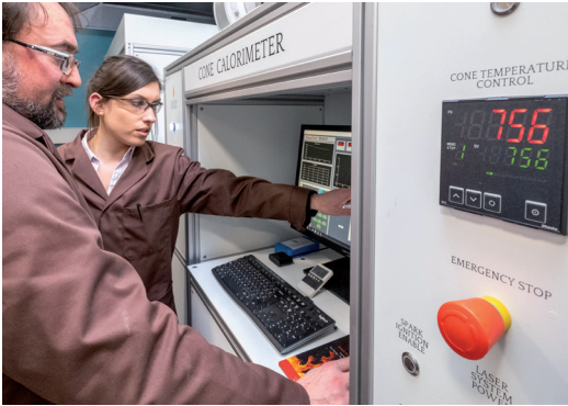
Analisi dei risultati dei test per ottimizzare le prestazioni Fuoco, Fumo e Tossicità (FST: Fire, Smoke and Toxicity)
