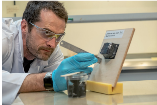
Test di incurvatura del nuovo adesivo Spabond
