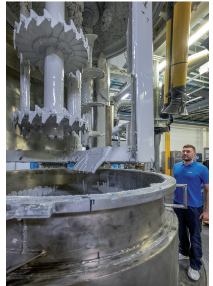
Uno dei mixer a tre alberi per la produzione di formulati
