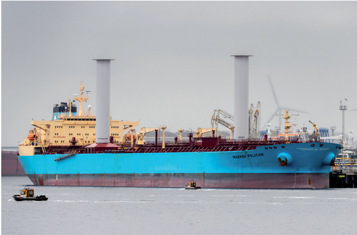
Due vele a rotore su un cargo
