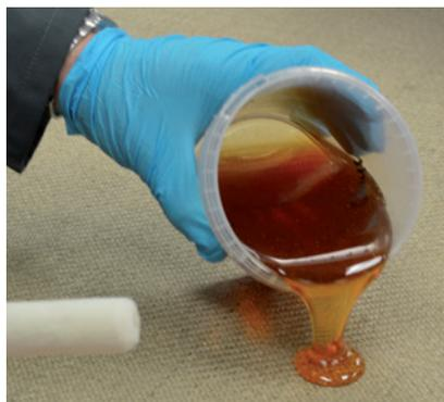
Una resina de baja toxicidad introducida en el 2019 para laminar un nuevo refuerzo de fibra natural.
