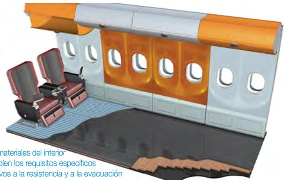
Los materiales del interior cumplen los requisitos específicos relativos a la resistencia y a la evacuación de humos y de calor
