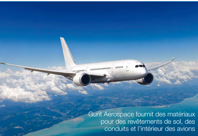
Boeing 787 « Dreamliner » fabriqué à 50 % à partir des matériaux composites.
