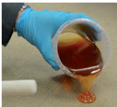
Ein 2019 eingeführtes Harz mit geringer Toxizität zum Laminieren einer neuen Naturfaserverstärkung
