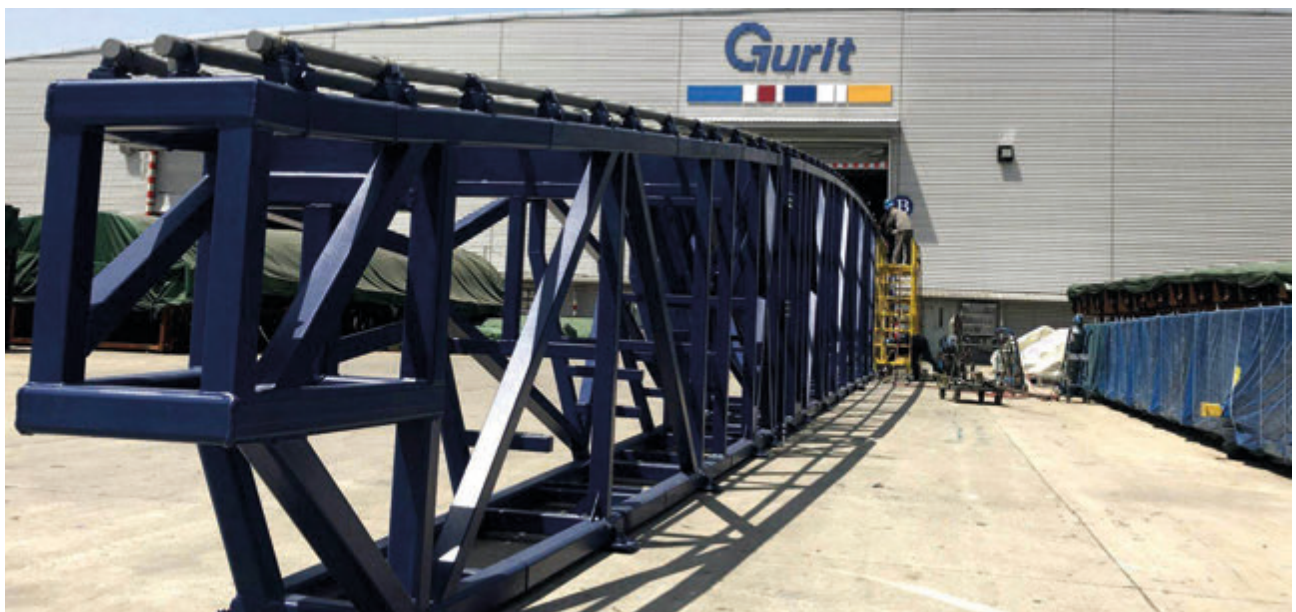
Bauteil einer Befestigungsvorrichtung für die Herstellung von Windturbinenblättern
