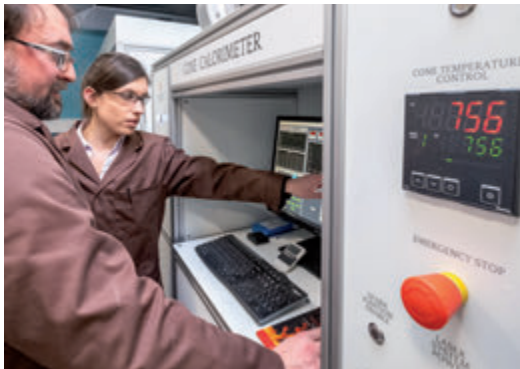
Analyse von Versuchsergebnissen zur Optimierung der Beständigkeit bei Feuer, Rauch und Toxizität (FST)
