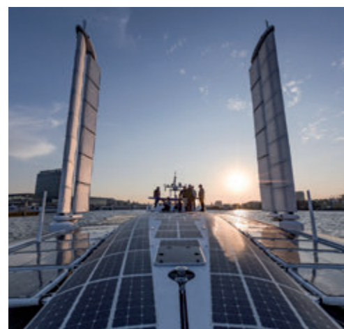
Oceanwings-Segel und Solarzellen der Energy Observer
