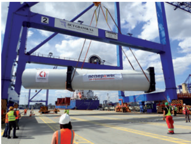
Leichte Verbundwerkstoffe als Wegbereiter für Rotorsegel
