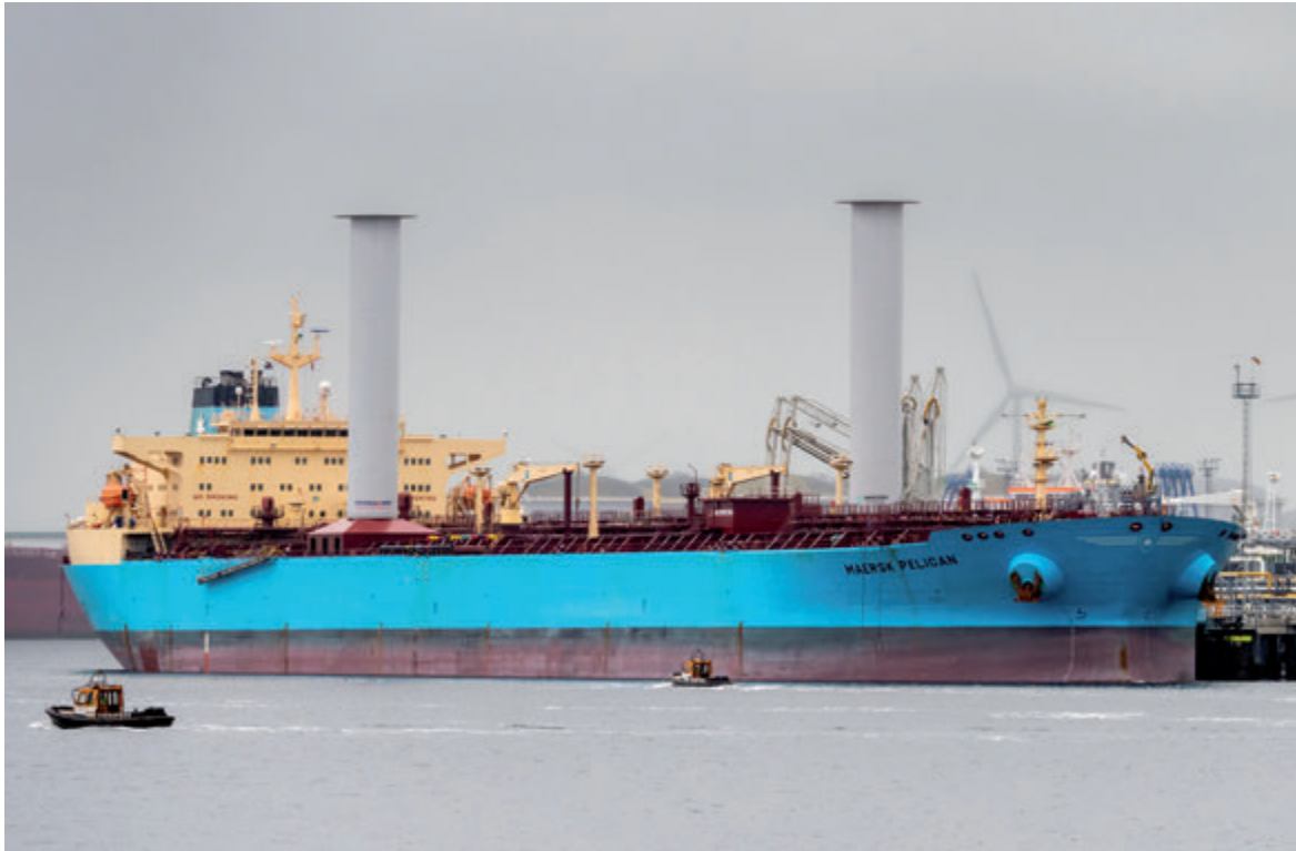
Zwei Rotorsegel auf Frachtschiff
