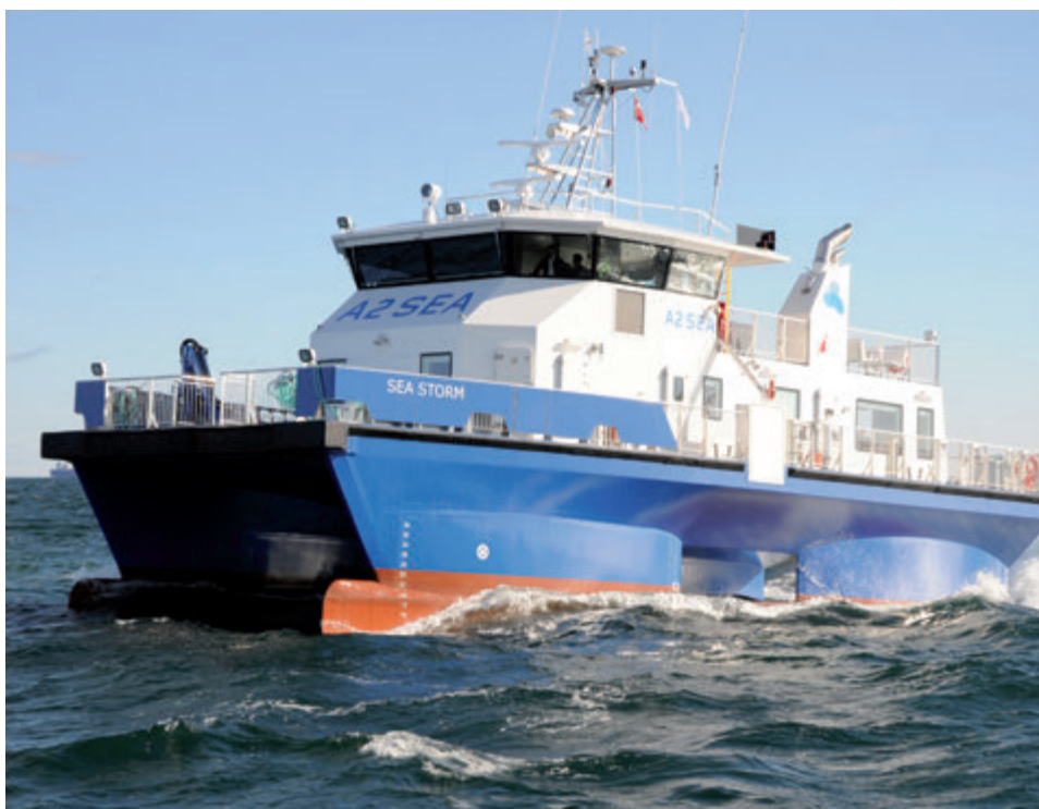
Aus Gurits Corecell™ gebautes Arbeitsschiff, das Arbeiter zu Windparks befördert
