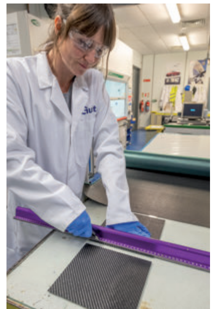
Vorbereitung von Prepreg-Laminaten für Tests
